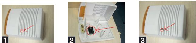
3. Utilice un destornillador Phillips (no incluido) para desenroscar el tornillo situado en la muesca «1» para abrir la tapa principal de la sirena.
