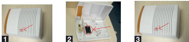
1. Utilisez un tournevis cruciforme (non fournit) pour dévisser la vis située sur l'encoche «1» afin d'ouvrir le capot principal de la sirène.
