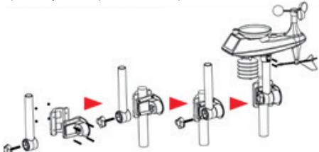
» Coloque la sonda en el tubo y luego ajuste su posición orientando el panel solar hacia el sur. (De lo contrario, la dirección del viento será incorrecta)
