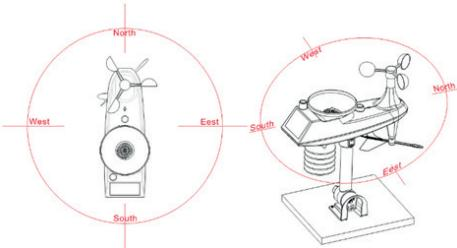
» Use a marca «N» na parte superior da sonda para orientá-la. Use uma bússola (não fornecida), bem como o nível de bolha embutido na sonda para encontrar a posição ideal. Fixe o conjunto com os 2 parafusos fornecidos na parte superior do tubo.
