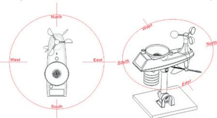
» Utilisez la mention «N» située sur le haut de la sonde pour l'orienter. Aidez-vous d'une boussole (non fournie) ainsi que du niveau à bulle intégré à la sonde pour trouver la position optimum. Serrez l'ensemble avec les 2 vis fournies sur le haut du tube.
