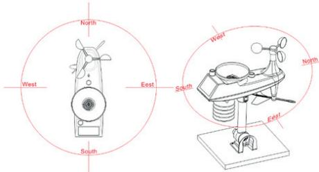
» Use la marca «N» en la parte superior de la sonda para orientarla. Utilice una brújula (no suministrada) así como el nivel de burbuja integrado en la sonda para encontrar la posición óptima. Apriete el conjunto con los 2 tornillos provistos en la parte superior del tubo.
