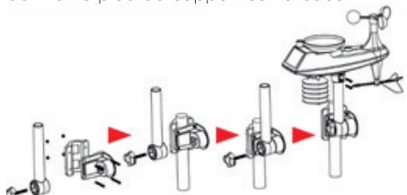
» Placez la sonde sur le tube puis ajustez sa position en orientant le panneau solaire face au sud. (Sinon, la direction du vent sera erronée)
