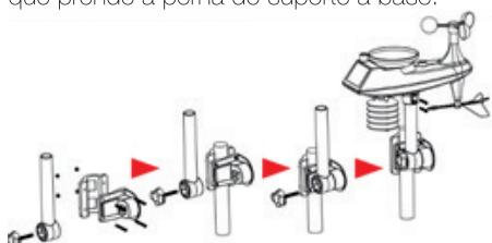
» Coloque a sonda no tubo e depois ajuste sua posição orientando o painel solar para o sul. (Caso contrário, a direção do vento estará errada)
