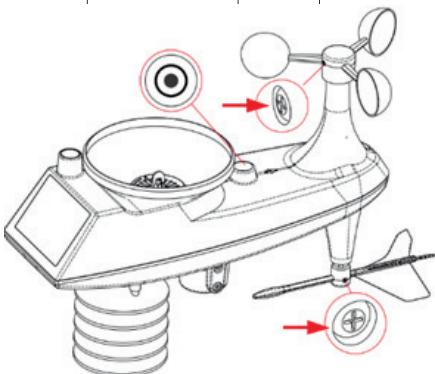
» Asegúrese de que los tornillos que sujetan la veleta y la veleta de medición del viento estén apretados.
