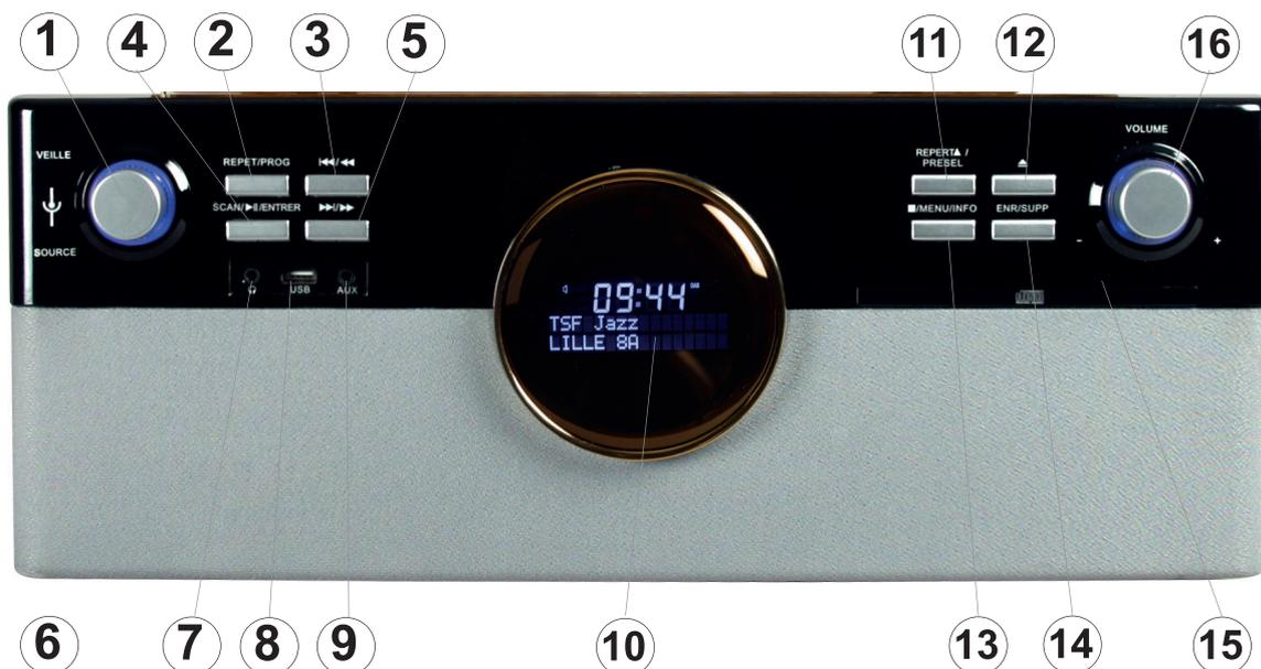
1. MARCHE / ARRÊT et source : Permet d'allumer/éteindre la platine mais également de sélectionner la source audio (Disque Vinyle, cassette, cdrom, USB, BT, radio FM, DAB...)
