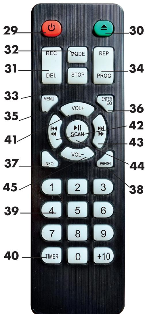
29. POWER : Permet d'allumer ou d'éteindre la platine.
